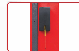
Un dispositivo de desbloqueo de seguridad manual que controla los bloqueos dobles.
